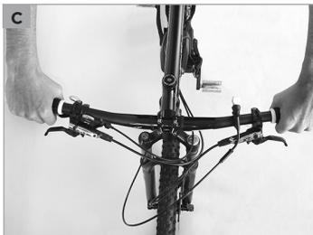
Drehen Sie nacheinander die Schrauben gleichmäßig und über Kreuz fest, d.h. abwechselnd und schrittweise, bis Sie mit dem Drehmomentschlüssel die Untergrenze der empfohlenen Schraubendrehmomente erreichen.
