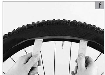
Ist ein Teil der Reifenflanke über den Felgenrand gehelbt, können Sie sie meist problemlos über den gesamten Umfang lösen, indem Sie einen Montierhebel verschieben.
