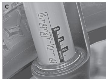
Zur Messung können Sie den Gummiring nutzen, der meist auf dem dünneren, eintauchenden Rohr der Federgabel sitzt. Sollte kein Gummiring vorhanden sein, schlingen Sie einen Kabelbinder um eines der Standrohre. Ziehen Sie ihn gerade so fest, dass er sich noch verschieben lässt, aber nicht von allein rutscht.
