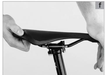
Beim **Ein-Schraubensystem (a)** ist die Sattelstütze für die meisten Sportsättel mit einem Sattelgestellrohrdurchmesser von 7 mm ausgelegt. Ebenfalls erhältlich sind Ersatz-Außenklemmen für ovalisierte Sattelgestellrohre von 8 mm x 8,5 mm (B x H) sowie für Carbon-Sattelgestellrohre, die größer als 8 x 8,5 mm sind. Wenn Sie nicht sicher sind, welchen Sattelgestelltyp Sie haben oder wenn Sie weitere Informationen benötigen, wenden Sie sich an Ihren SCOTT-Fachhändler.
