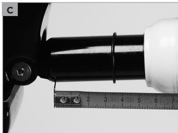
Zur Messung können Sie den Gummiring nutzen **(b)**, der meist auf dem dünneren, eintauchenden Rohr des Federbeins sitzt. Sollte kein Gummiring vorhanden sein, schlingen Sie einen Kabelbinder um das dünnere Rohr. Ziehen Sie ihn gerade so fest, dass er sich noch verschieben lässt, aber nicht von allein rutscht.
