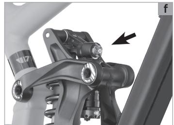
Führen Sie nach jeder Änderung der Einstellung eine Probefahrt durch möglichst vielseitiges Gelände durch. Überprüfen Sie danach die Position des Gummirings/Kabelbinders. Sein Abstand zum Abstreifer ist der maximale Federbeinhub, den Sie genutzt haben.
