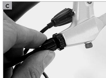
Alternativ kann der Zug auf die gleiche Weise direkt an der Bremse nachgestellt werden. Überprüfen Sie nach dem Nachstellen die Funktion und ob die Beläge schleiffrei sind, wenn Sie den Bremshebel loslassen und das Laufrad drehen **(d)**. Wenn Sie mehrfach nachstellen, ändert sich die Stellung des Hebels am Bremsattel. Die Wirkung der Bremse wird schwächer. Im Extremfall kann die Bremse komplett ausfallen. Unfallgefahr!
