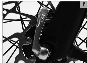
Danach muss die Hebelkraft deutlich zunehmen, der Hebel darf sich am Ende nur schwer bewegen lassen. Benutzen Sie den Daumenballen und ziehen Sie zur Unterstützung mit den Fingern an einem festen Bauteil, z.B. an der Gabel **(a)** oder Hinterbaustrebe, nicht jedoch an einer Bremsscheibe oder Speiche.
