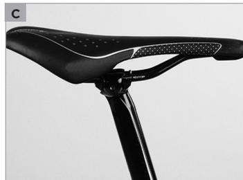
Passt der Sattel, schieben Sie ihn auf der Stütze so hin, dass das Gestell vom Befestigungsmechanismus der Stütze mittig geklemmt wird. Stellen Sie zudem die Satteloberkante parallel zum Untergrund ein. Drehen Sie die Schraube schrittweise an und stellen Sie sicher, dass
