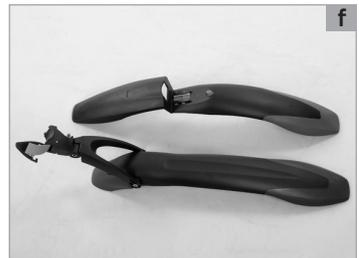
Nachrüstbare Radschützer zum festen Anbringen bestehen in der Regel aus Kunststoff und werden mit Hilfe der zusätzlich angebrachten Streben in der richtigen Position gesichert. Die Länge der Strebe ist dann optimal, wenn die Unterkante des Radschutzes etwa 15 mm entfernt ringförmig parallel zum Reifen verläuft. Achten Sie auch darauf, dass weder Bremsen noch die Lenkung beeinträchtigt werden.
