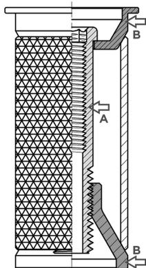
5. Verwenden Sie einen 6-mm-Innensechskantschlüssel um die Expanderschraube zu lösen **(A)** bis die oberen und unteren Spannkeile **(B)** frei drehbar sind.
