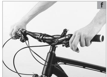
Bei **Scheibenbremsen** muss der Druckpunkt sofort stabil sein. Lässt sich erst nach mehrmaligem Betätigen des Bremshebels ein stabiler Druckpunkt erfühlen, sollten Sie Ihr SCOTT-Bike sofort bei Ihrem SCOTT-Fachhändler überprüfen lassen.
