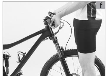
Richten Sie ggf. die Bauteile aus und drehen Sie die Schrauben vorsichtig fest, bis die Bauteile sicher klemmen **(a)**. Die maximalen Schraubendrehmomente finden Sie auf den Bauteilen aufgedruckt oder in den Anleitungen der Komponentenhersteller.
